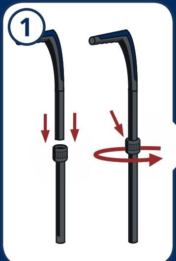
**HINWEIS:** Drehen Sie die Rohrteile nach dem Aufbau nicht mehr auseinander.
